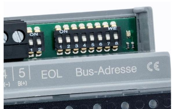
Mit dem EoL Switch (zweipoliger Dipschalter) kann der Bus aktiv (560R / 120R / 560R) terminiert werden.
