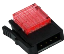
Ethernet Stecker Rot 4-polig für Patchkabel / CAT Werkzeuglose Montage (Schneidklemme / 0.14-0.25mm 2 )
