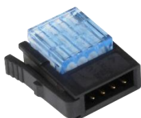
Ethernet Stecker Blau Anschlussstecker Ethernet 4-polig für die powerIO®-Line an der powerIO®-Box oder powerIO®-Start Unit. Bei powerIO®- Box im Lieferumfang enthalten. Werkzeuglose Montage (Schneidklemme / 0.25-0.50mm 2 )
